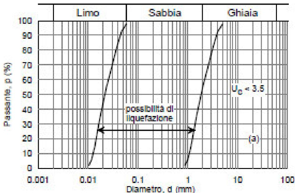
Figura 3 - Figura 7.11.1(a) delle NTC 2018 - Fusi granulometrici di terreni suscettibili di liquefazione per  $U_c < 3.5$
