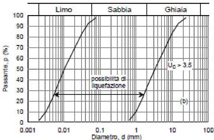
Figura 4 - Figura 7.11.1(b) delle NTC 2018 - Fusi granulometrici di terreni suscettibili di liquefazione per  $U_c > 3.5$
