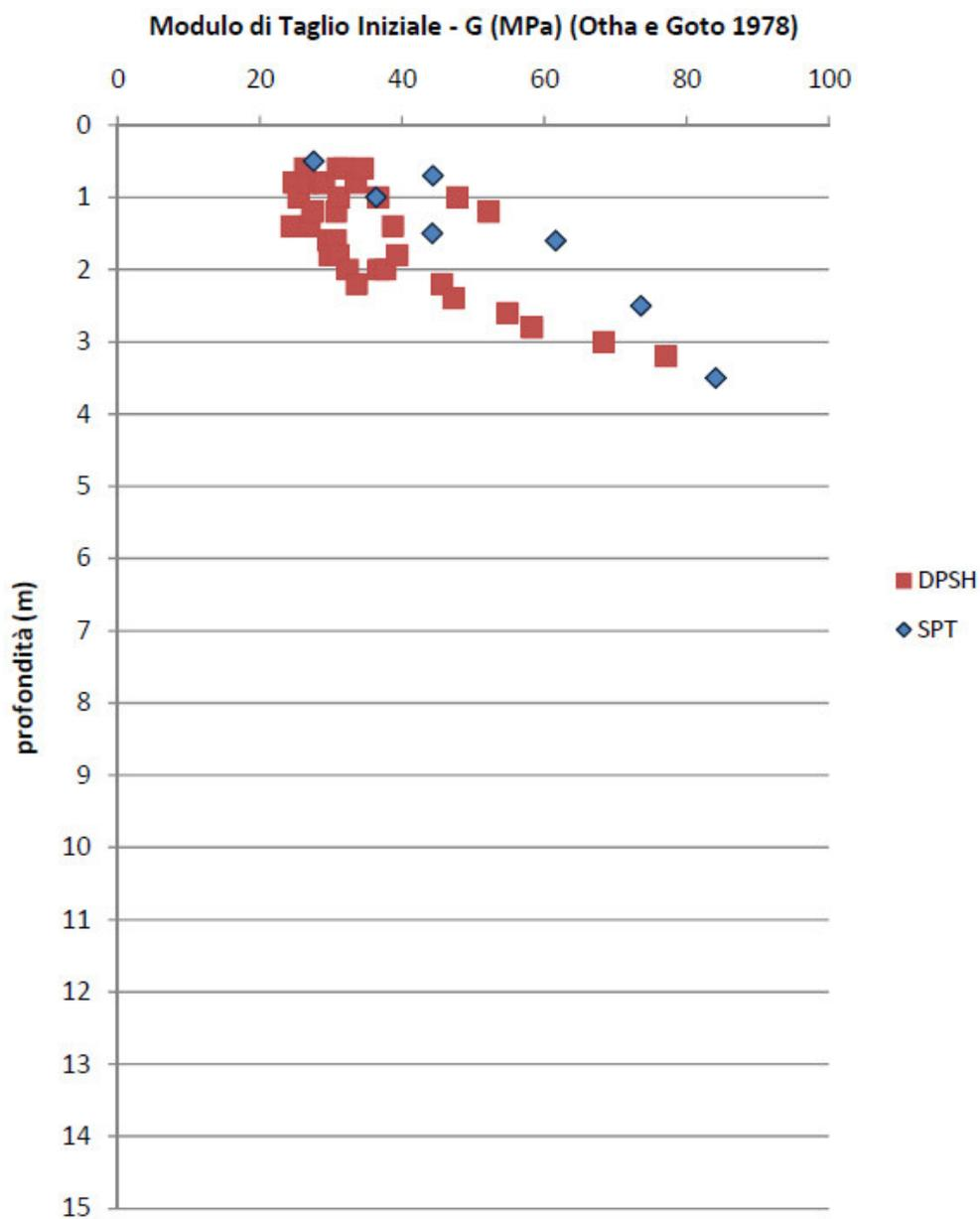
Figura 6.25 – Modulo di taglio iniziale da prove SPT e DPSH nei materiali R1
