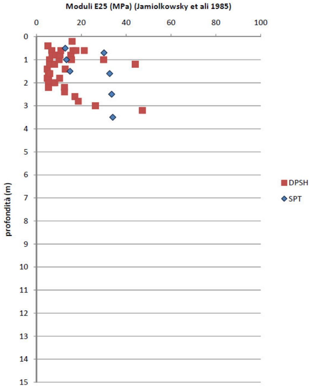
Figura 6.26 - Modulo di deformabilità operativo da prove SPT e DPSH nei materiali *Ri*
