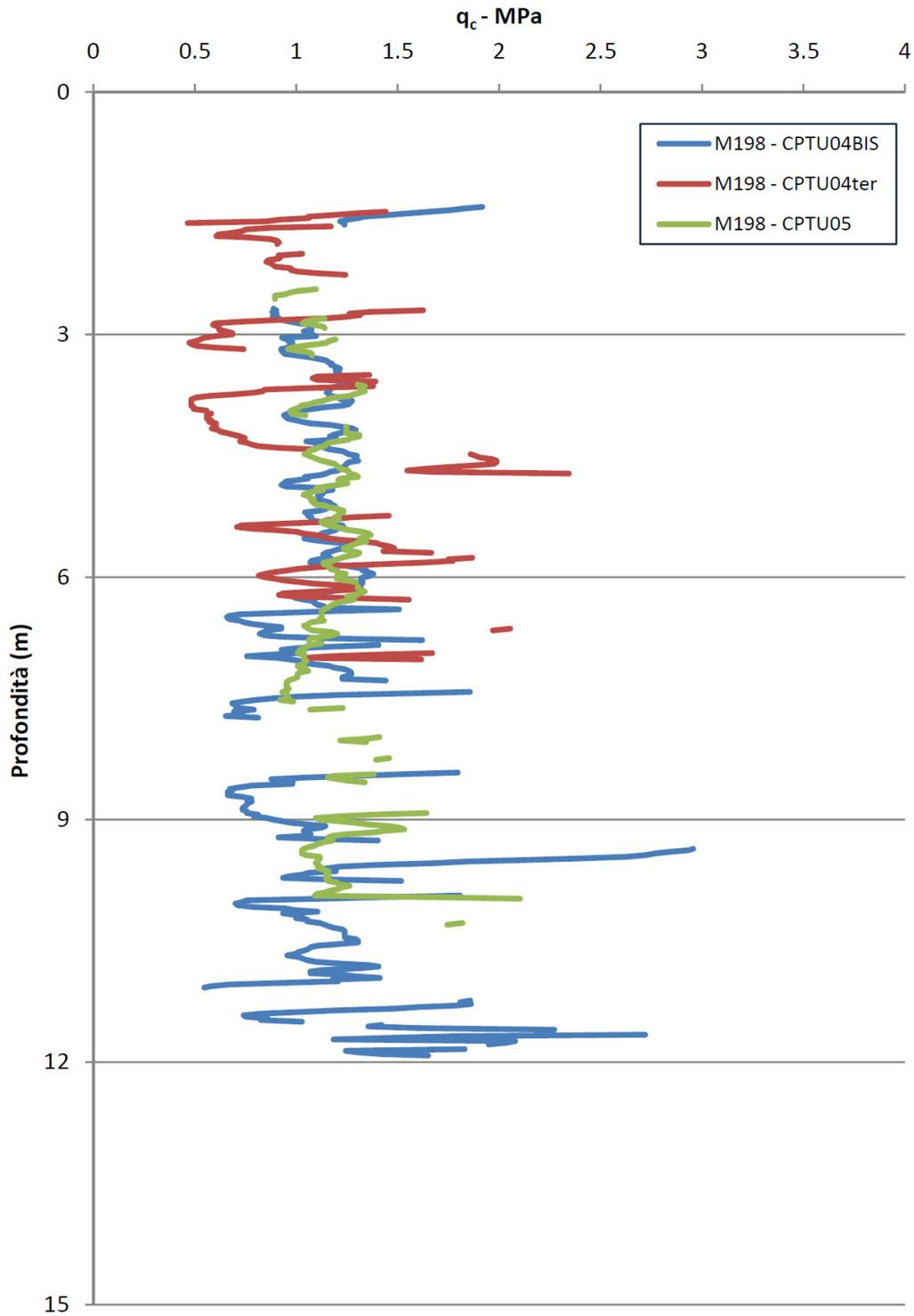
Figura 6.1 – Resistenza alla punta della prova CPTU nei materiali AL
