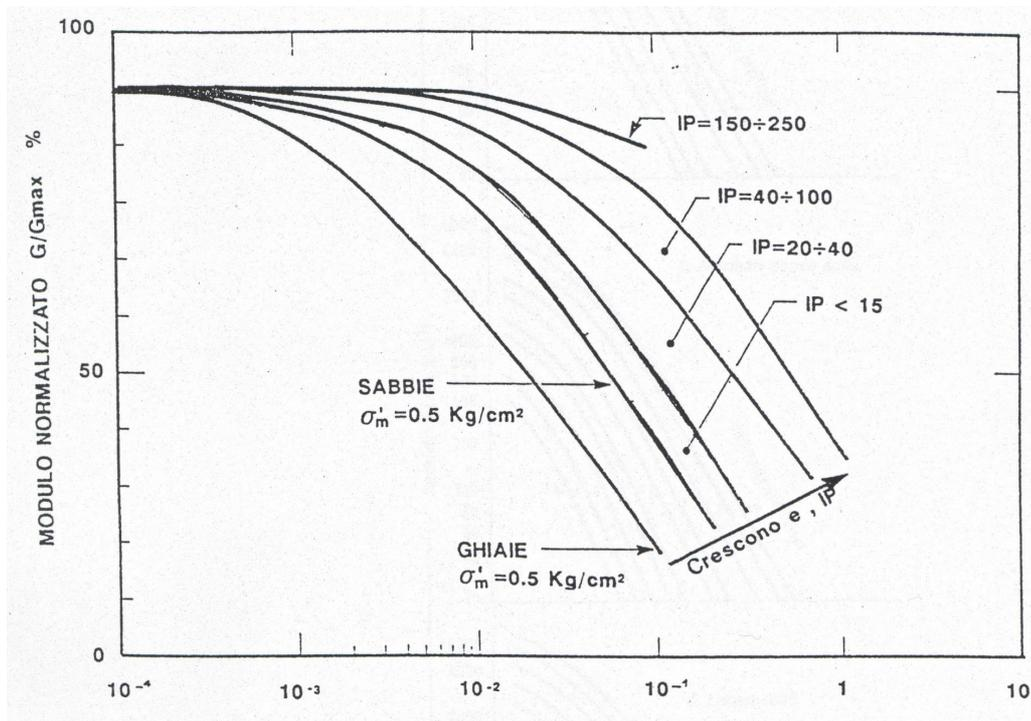
Figura 4.3 - Degrado del modulo G per vari tipi di terreno (da Lo Presti 1989)
