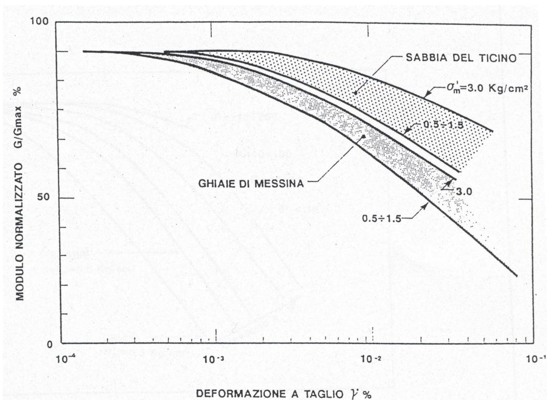
Figura 4.2 - Degrado del modulo G per terreni incoerenti (da Lo Presti 1989)
