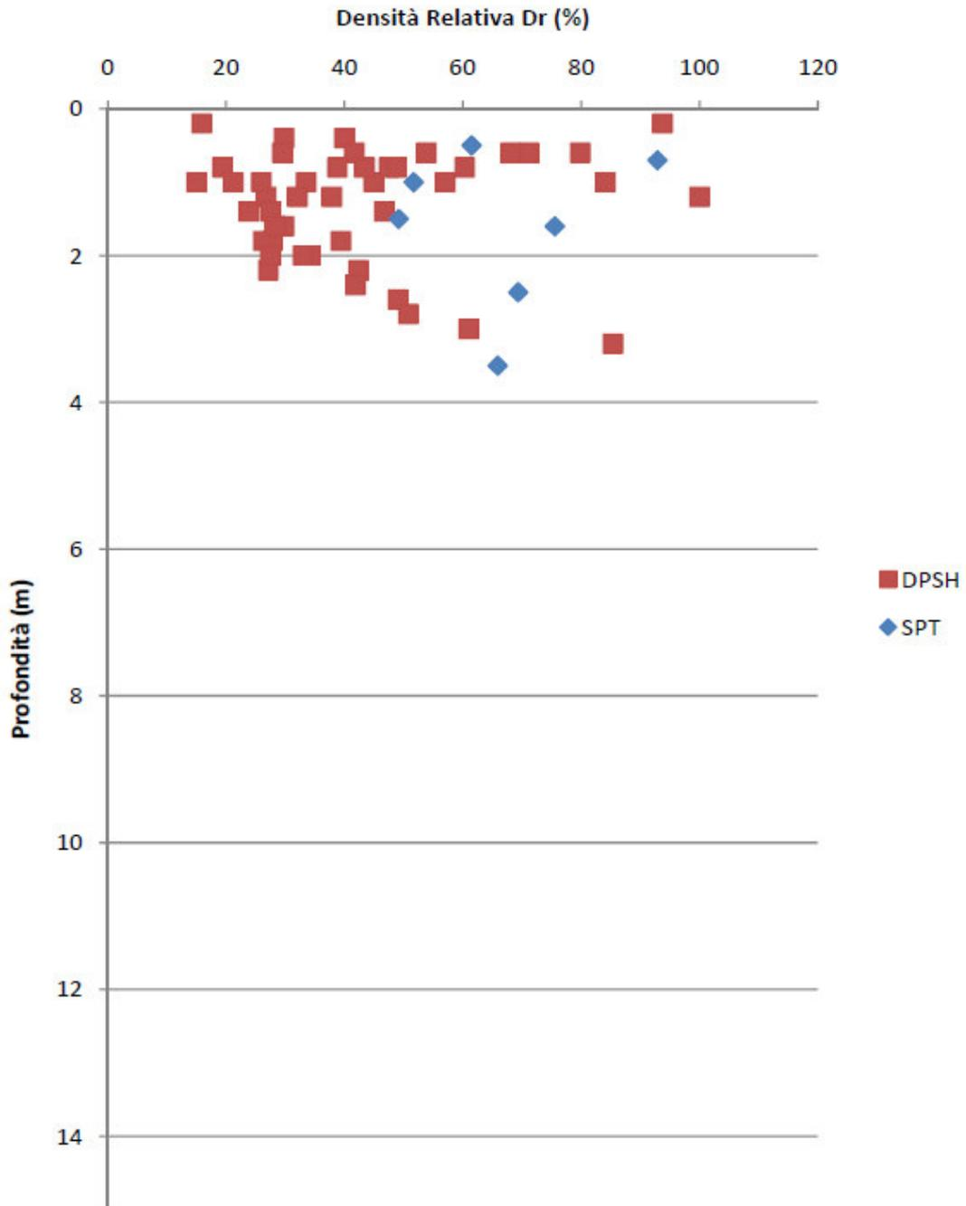
Figura 6.23 – Densità relativa da prove SPT e DPSH nei materiali  $R_i$
