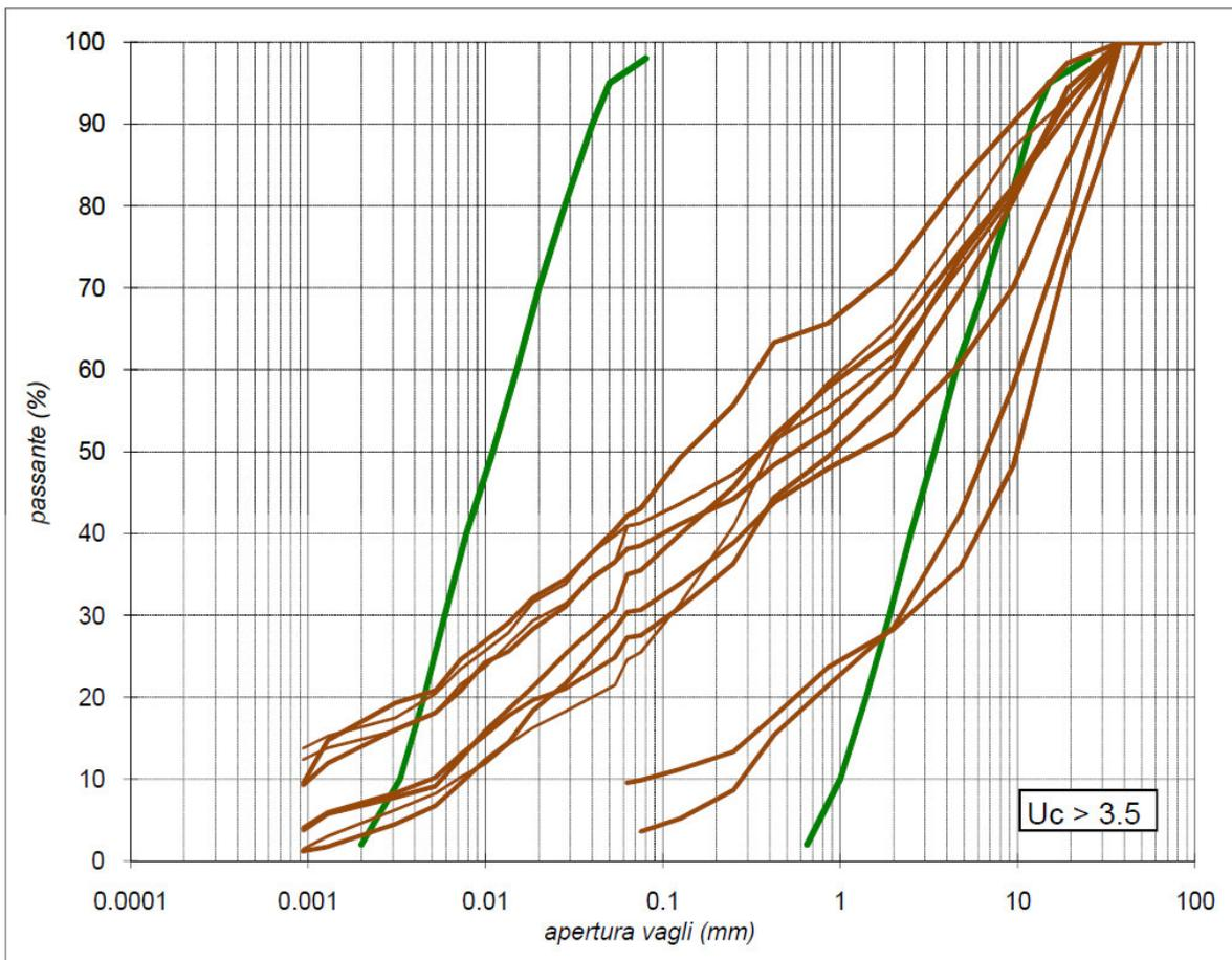
Figura 6 – Fusi granulometrici per l'unità GS con limiti di liquefazione
