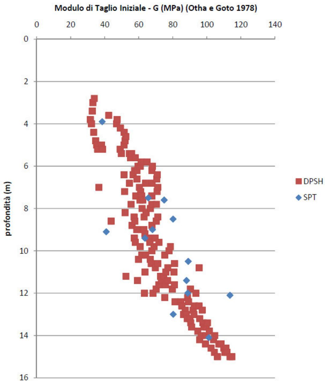
Figura 6.19 – Modulo di taglio iniziale da prove SPT e DPSH nei materiali GS
