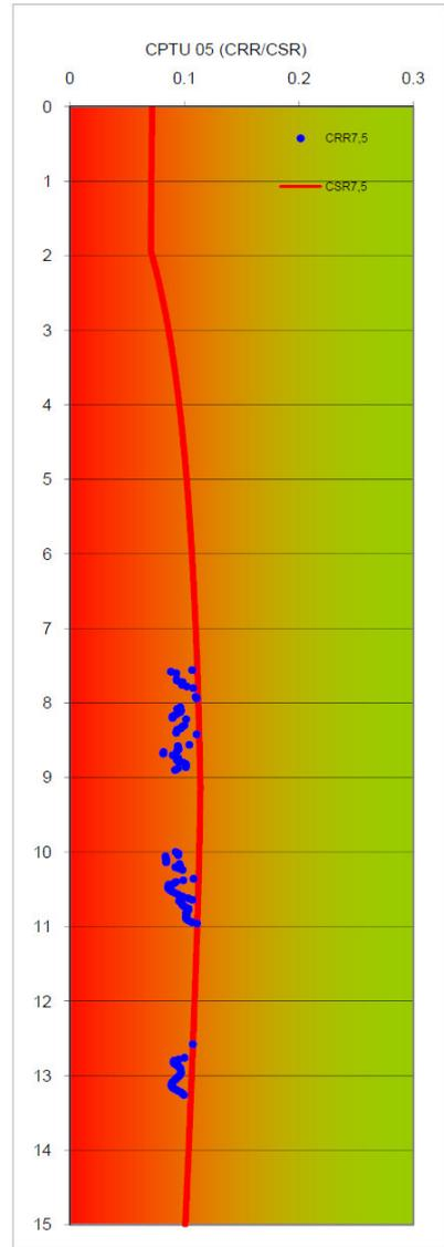
Anche la verifica alla liquefazione eseguita sulle prove SPT eseguite in foro, con il metodo di Idriss e Boulanger 2008 (di seguito riportato), ha confermato l'assenza di rischio di liquefazione per i terreni investigati alle condizioni sismiche di progetto.
