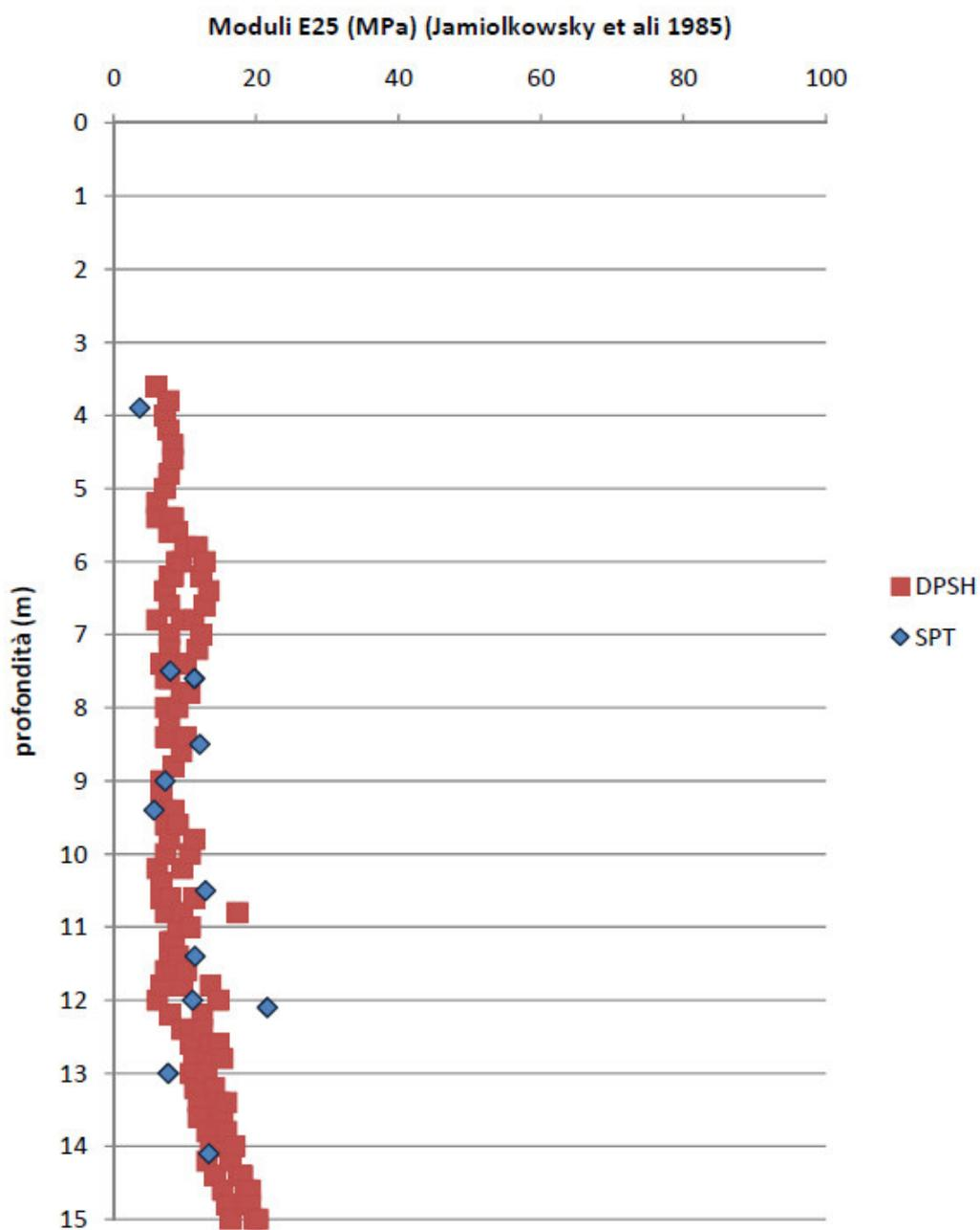
Figura 6.20 - Modulo di deformabilità operativo da prove SPT e DPSH nei materiali GS
