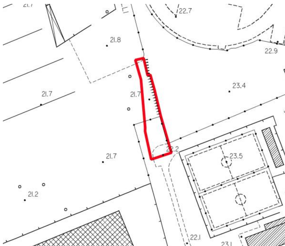
Figura 6 – Area di indagine georadar
